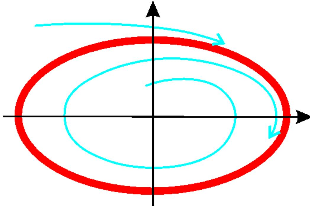
На фазовой плоскости автоколебания изображаются в виде замкнутой изолированной траектории – ПРЕДЕЛЬНОГО ЦИКЛА
