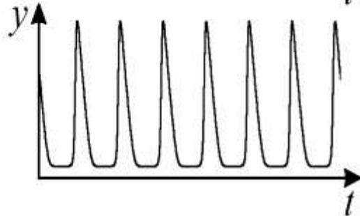
$v$  – колебания с постоянной амплитудой и фазой (предельный цикл на фазовой плоскости),  $\alpha = 6$ ;  $r = 0.24$ .
