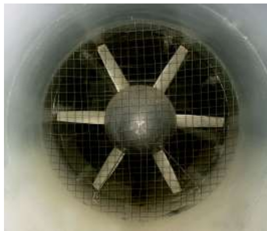
Импеллер нагнетает воздух в трубу
