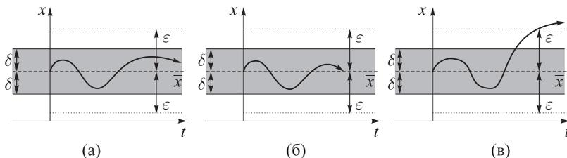
**Рис. 1.1.** Иллюстрация определения устойчивости стационарного состояния (обозначено пунктиром): а) состояние устойчиво по Ляпунову; б) состояние асимптотически устойчиво; в) состояние неустойчиво
